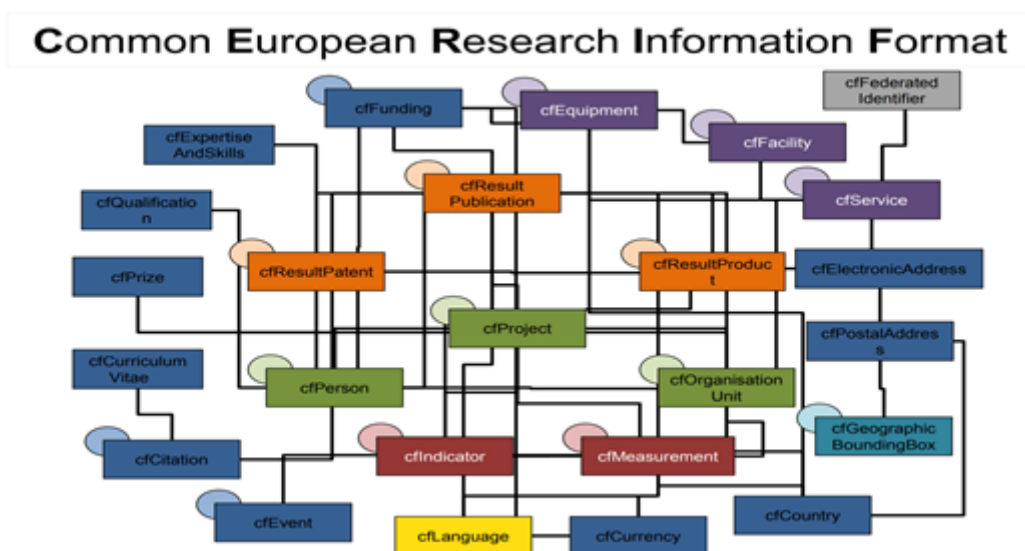
Gráfico 1. Entidades CERIF. El color verde representa las entidades principales del entorno de investigación, las de color naranja son entidades que representan los resultados de la investigación, las de color púrpura son las entidades de infraestructura de investigación, las de color marrón son las entidades de indicador y medición, las entidades de segundo nivel de apoyo a la investigación. La entidad de color celeste representa la geolocalización.
